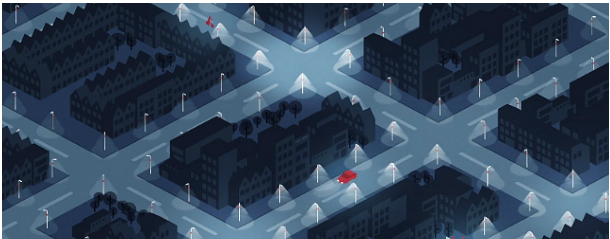
Foto: Detectiesysteem, het licht is aan/brandt feller op die locaties waar verkeerdeelnemers zijn.
