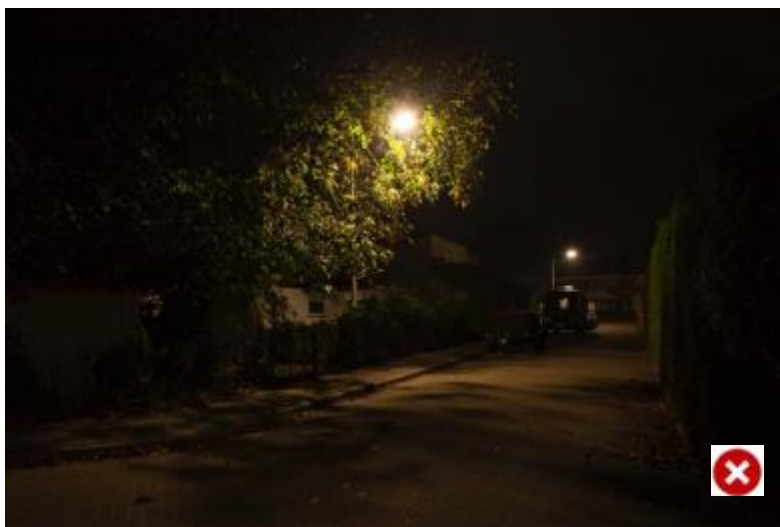
Foto: Burgemeester van Lyndenpark in Valburg. Lantaarnpaal staat in de boom en geeft niet voldoende licht meer op de weg daardoor. Door goede afstemming kan dit voorkomen worden.
